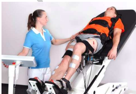
robotický eksoskeleton vyvinutý pro americkou armádu, nyní pro civilní využití v rehabilitaci
